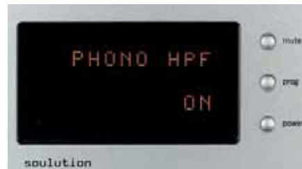
Bei Bedarf kann dem Phonoeingang ein Rumpelfilter zugeschaltet werden
